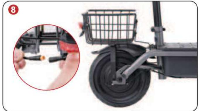
SK Pripevnite zadný kôš ku kolobežke, utiahnite jeho skrutky a potom znovu pripojte napájací kábel zadného svetla.
