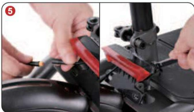
SK Odpojte napájací kábel predinštalovaného zadného svetla na trubke sedadla. Odstráňte skrutky zadného svetla, potom zadné svetlo.
