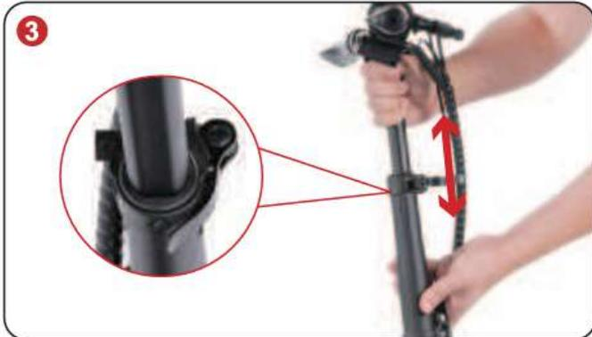
SK Nastavte riadidlá na požadovanú výšku a potom sponu bezpečne zatvorte.
